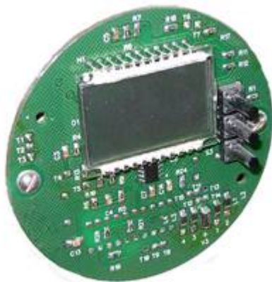
Рис.1. Внешний вид платы электронного преобразователя
